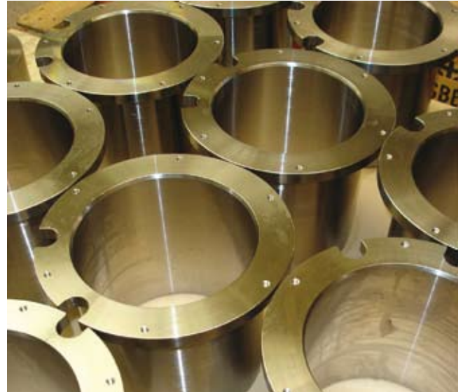
La machine Hyundai permet à Lai Mécanique de terminer les pièces sur la machine, y compris les fraisages, alésages et taraudages.
