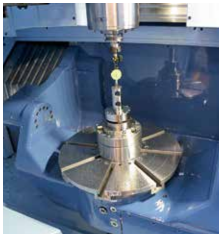
Diviseur intégré permettant d'usiner des cylindres de diamètre maximum de 520 mm et d'une hauteur de 350 mm.
